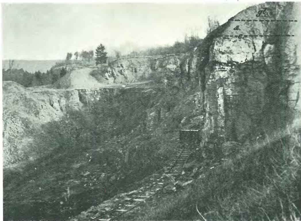
Photo Nr. 8. — Tagebau am Nordsaum des Titelberg bei Rollingen. Es bedeuten: gl. = Glimmermergel; a. = Concavuszone; e. = Emersionsfläche mit flachen Geschieben über dem Dachkalkstein. (Zu p. 97.) Über der Plattform in der Mitte des Bildes werden Unterkalk (1) und Oberkalk (3) abgebaut.
