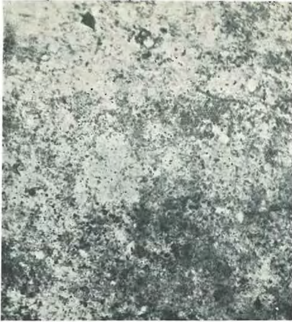
Fig. 7. Microphotographie d'un schiste de Schouweiler (lumière ordin., grossissem. 200). (Phot. Waldem. Schumacher)
