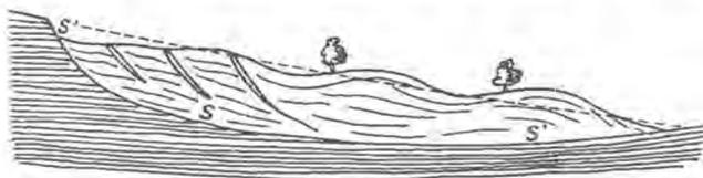
Fig. N° 48. — Forme d'un sol en glissement. S, S' = surface d'arrachement. La ligne en tireté donne la forme du versant avant le glissement.
